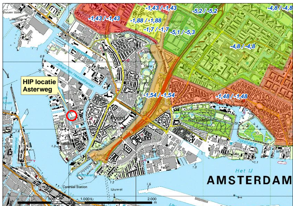
Figuur 2.2: Overzichtskartaal van de regio met gehanteerde polderpeilen (zomerpeil / winterpeil in m t.o.v. NAP)
