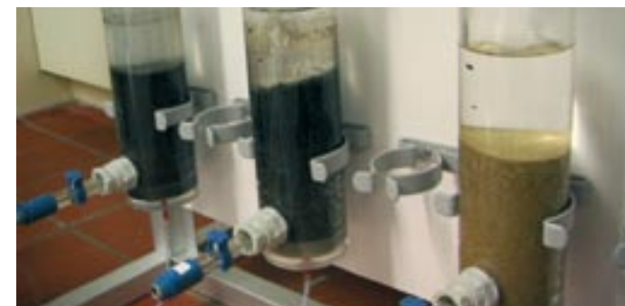
Figuur 6.3 Kolomopstelling voor onderzoek van gestimuleerde sulfideprecipitatie. In de zwart gekleurde kolommen 1 en 2 treedt sulfideprecipitatie op als gevolg van dosering van melasse, in de referentiekolom 3 gebeurt dit niet.
