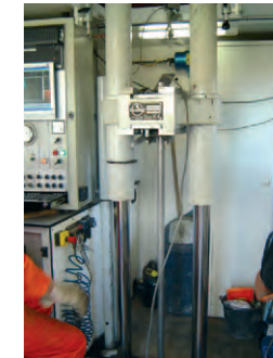
MIP-sondering: sondeerstang en detectieapparatuur
