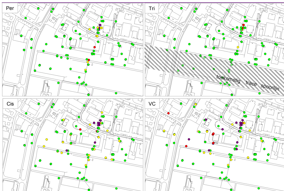
Figuur 6.6 Bovenaanzicht van de verontreiniging in het grondwater met Per, Tri Cis en VC voor voorbeeld 4. De tekeningen zijn noord georiënteerd. © Tauw bv, 2010
