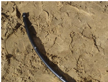
(b) Onderkant slang met 3 elektrodes.
