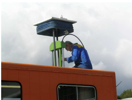
(e) Elektrode kabel wordt via het dak van de sondeerwagen in de sondeerbuis geplaatst.
