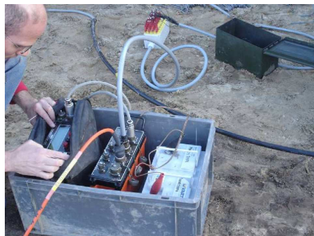
(j) Het testen van de elektrodes met het geo-elektrische apparaat.
