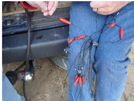
(h) Het aanbrengen van 26 bananenstekkers op de sondeerkabel.
