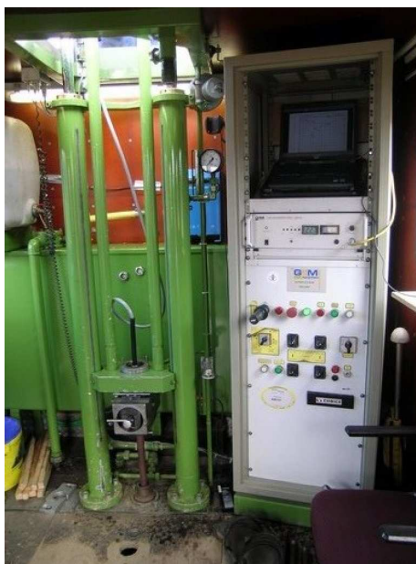
(f) In de sondeerwagen met elektrode kabel (grijs) die uit de slang (zwart) komt.
