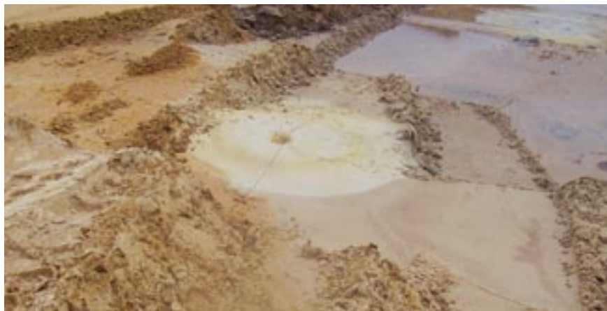
Invloedsstraal in situ chemische oxidatie, zichtbaar na ontgraving (bron Tauw)
