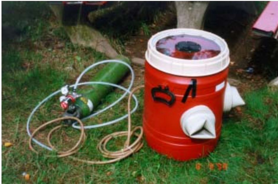
1. Het anaërobe monsternamevat, met de cylinder stikstofgas
