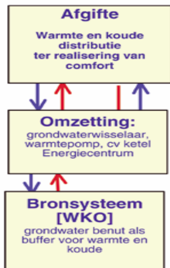
Figuur 3 Weergave klimaatinstallatie met onderdeel bodemenergiesysteem
