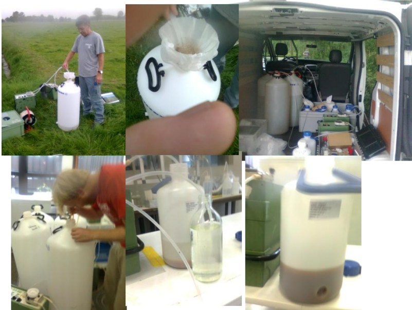
Figuur 3: Fotocollage van de veldbemonstering, de verwerking van de monsters en het naar ETH Zurich opgestuurde monster. Linksboven: Het 60 L vat wordt met een slangenpomp gevuld. Bovenmidden: Tijdens het vullen wordt het water gefiltreerd door een 1 \mu\text{m} filterdoek. Rechtsboven: Na het bezinken van het mineraal bruciet ( \text{Mg}(\text{OH})_2 ) worden de 60 L vaten afgepompt tot \sim 10 L. Linksonder: In het lab wordt gericht het bruciet opgepompt en overgebracht naar een 5 L vat ( Ondermidden ). Rechtsonder: Nadat het monster is aangezuurd met salpeterzuur ( \text{HNO}_3 ) lost het bruciet op en is de fosfaat uit de 60 L geconcentreerd in de resterende hoeveelheid ( \sim 5 L). Dit laatste proces wordt herhaald totdat er een volume van \sim 200\text{ml} over is.
