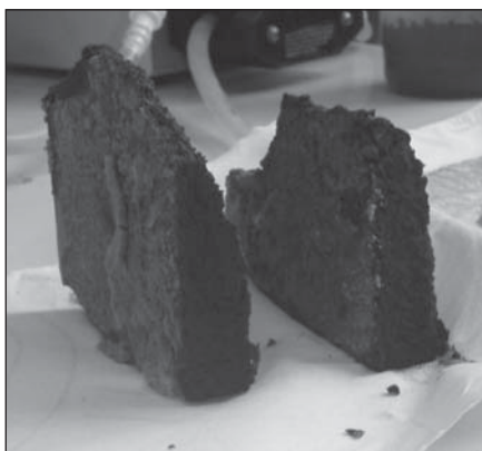
FIGUUR 4: STUKJES VERSTERKTE BAGGERSPECIE AFGE-BROKEN VAN DE CONTINUE LAAG 1 DAG NA DE LABORATORIUMPROEF
