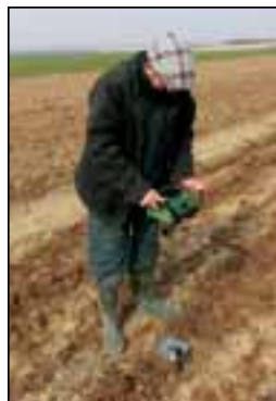
Diagnostic des tassements au pénétromètre.
