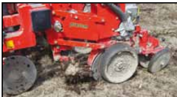
Les chasses débris montés sur le semoir permettent d'assurer un bon contact sol/graine.
