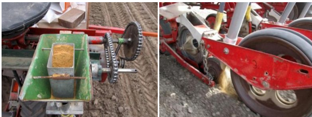
Figuur 6. Aangepaste apparatuur om organische producten tijdens zaai toe te dienen (foto's IRS)
