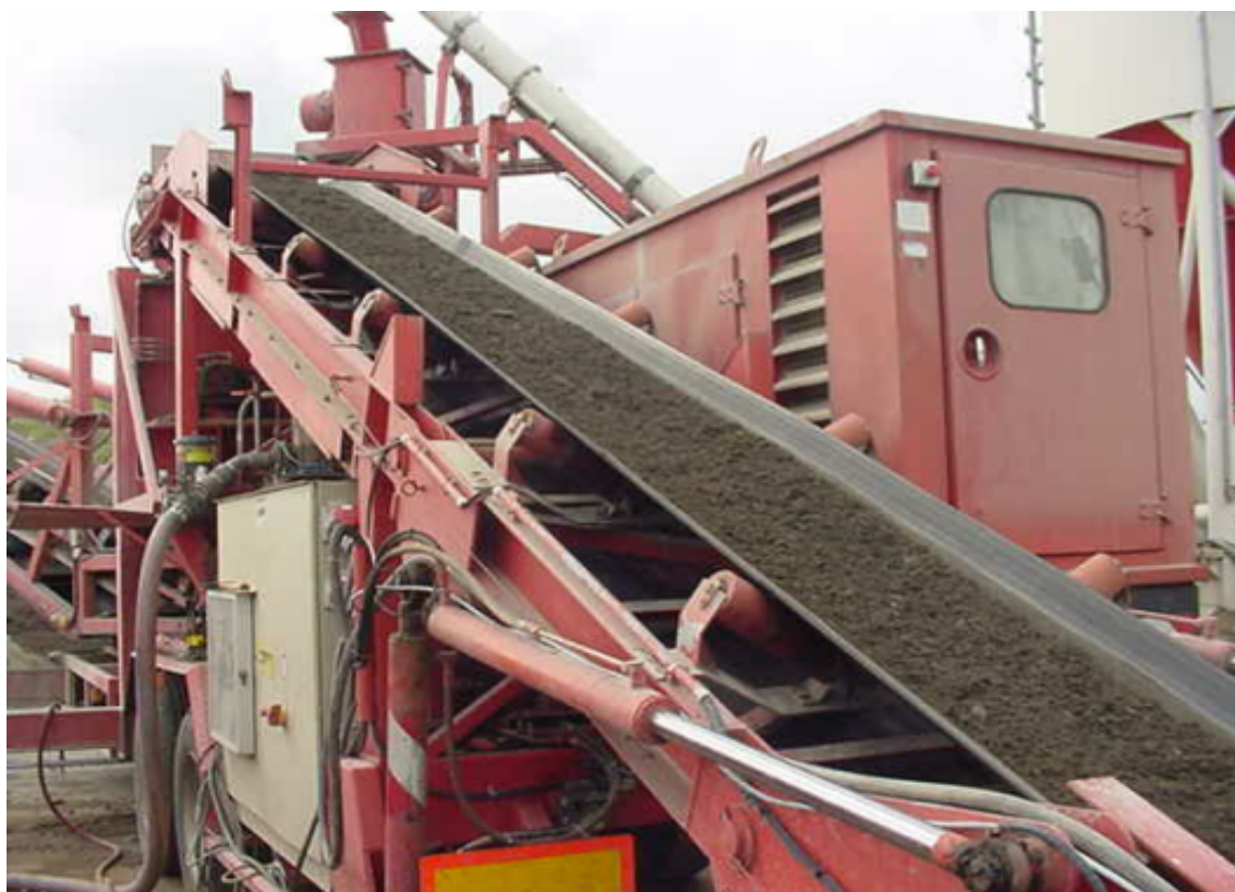
Fig. 4. Detailopname van de transportband naar de dwangmenger.
