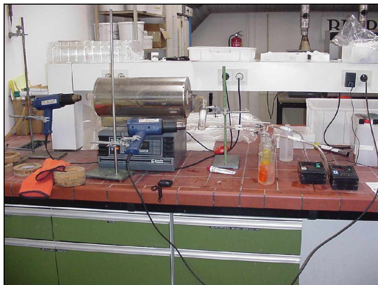
Fig. 16. Opstelling stookproeven. Buisoven, impingers en pompjes.
