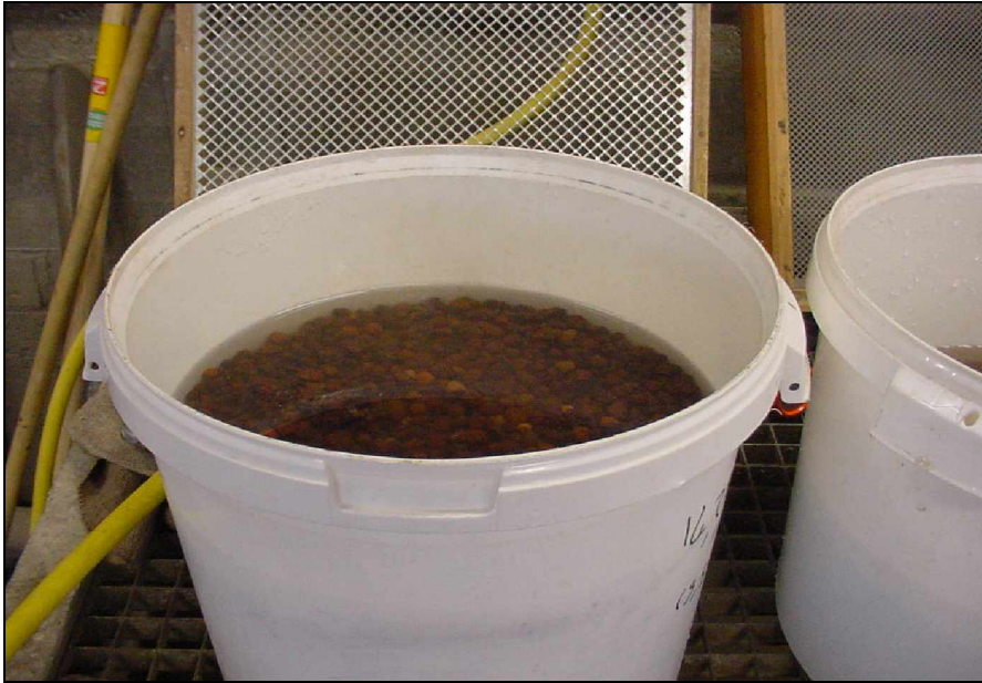
Fig. 17. Het onder water zetten van de pellets.
