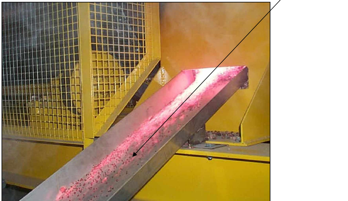
Fig. 13. Het product: de Trefoil LWA-korrels.
