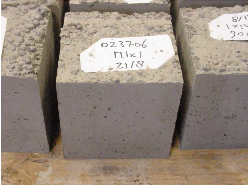
Fig. 19. Mengsel Mix 1. Dit mengsel ziet er ook schraal uit. Zetmaat is volgens recept (zonder toevoeging van Superplast) na aanmaak 135 mm. Luchtgehalte 5%v/v. De proefstukken zijn goed te verdichten op de triltafel. Ook na ontkisten zien ze er goed uit.
