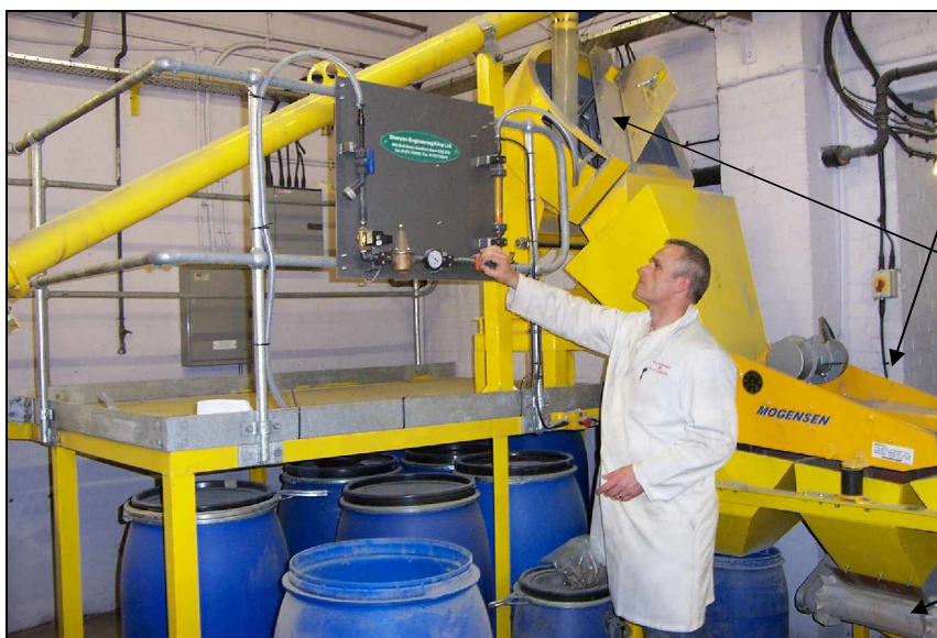
Fig. 9. Pelletisatie en afzeven grof en fijn materiaal.
