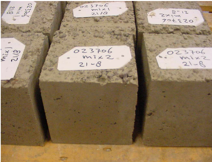
Fig. 20. Mengsel Mix 2. Dit mengsel ziet er, evenals mengsel Mix 1, schraal uit. Zetmaat is volgens recept, dus zonder Superplast 115 mm. Luchtgehalte 7,8%v/v. Proefstukken zijn goed te verdichten op triltafel. Ook na ontkisten zien ze er goed uit.
