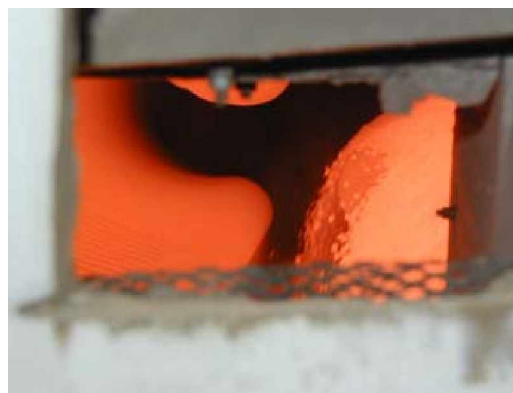
Fig. 2. Binnenkant oven met rollend grind tijdens productieproces.
