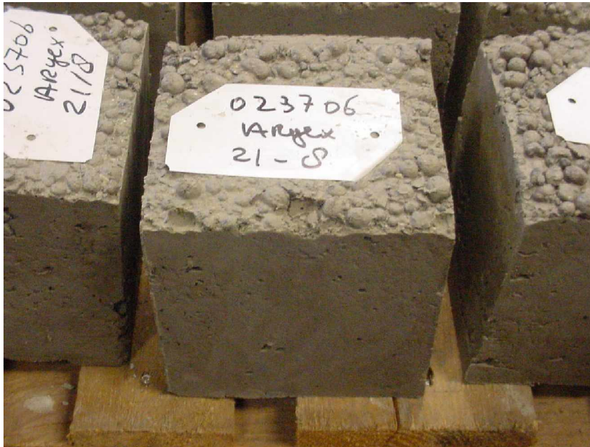
Fig. 21. Mengsel Argex. Het toeslagmateriaal heeft een lage vol. massa. Dit gaf problemen bij het onder water zetten en tijdens het mengen in de mixer. Zetmaat na aanmaak was 220 mm. Luchtgehalte 9,0%v/v. Bij het verdichten met de triltafel is er sprake van enige ontmenging. De grove korrels komen tijdens het trillen omhoog. Dat is ook na ont-kisten te zien.
