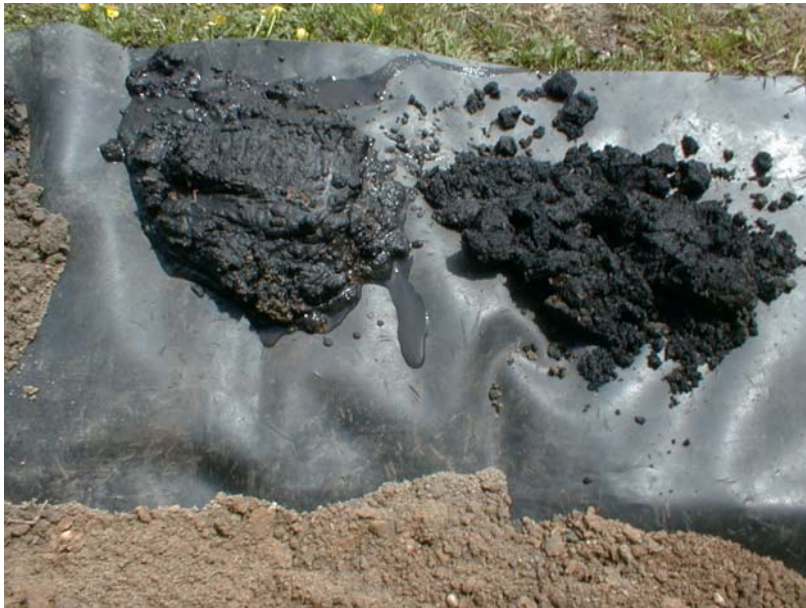
Fig. 4. Boorprofiel met mijnslik.
