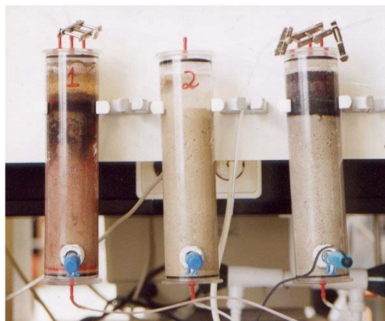
Figuur 5.8. Foto van de situatie tijdens Periode 3 met Na 2 S-toediening aan Kolom 3. Duidelijk te zien zijn de beginnende zwartkleuring van de grond in Kolom 1 door biologische sulfaatreductie en de daarop volgende FeS(s)-precipitatie en het kleurverschil tussen de grond in Kolom 2 en 3, ook hier door het neerslaan van FeS(s). De rode kleur van Kolom 1 wordt veroorzaakt door de aanwezigheid van (wellicht methanogene) bacteriën.
