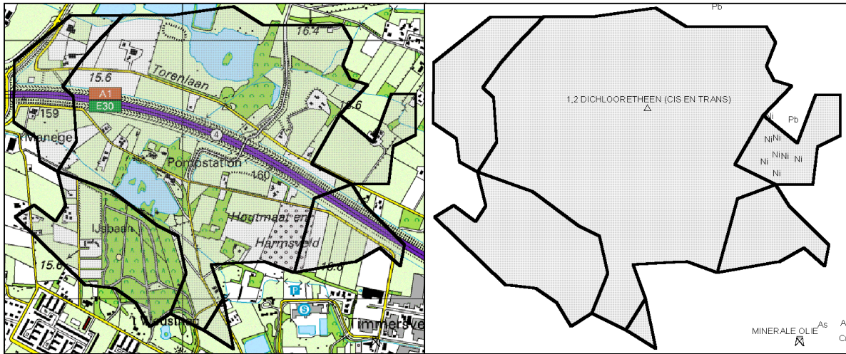
Fig. C2a. Topografie, verontreinigingen en intrekgebied van PS Hasselo. Omdat PS Hasselo een reeds bestaande onttrekking is, is er bij de stadsuitbreiding rekening gehouden met het grondwaterbeschermingsgebied. Het landgebruik is dan ook overwegend natuurlijk en agrarisch.
