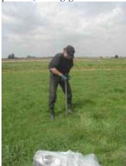
Foto 2.1: Vaststellen van de exacte locatie van een demping met behulp van een grondboor.
