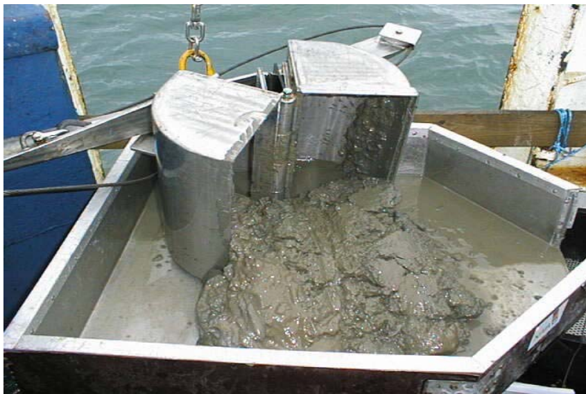
Fig. 6. Baggeren als maatregel voor risicoreductie.
