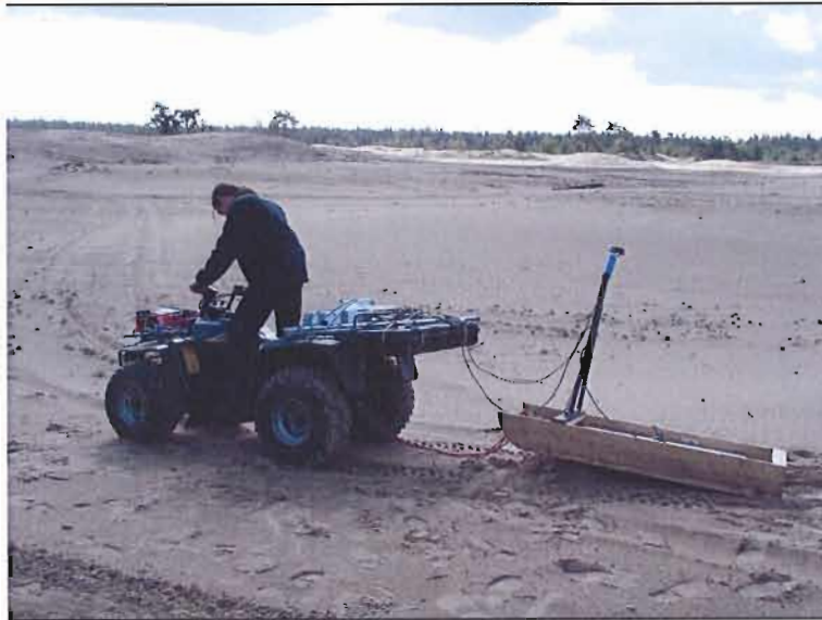
Figuur 3 Quad met daaraan gemonteerd de Medusa-sensor (achter op de bagagedrager van de Quad) en de grondradar (antenne achter de Quad)
