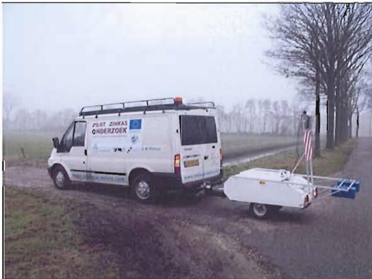
Figuur 4 Voorbeeld van een 'carborne' meetsysteem. Twee luchtgekoppelde radarantennes (twee blauwe doze) achter op de meetkar en een gammasensor (Medusa) is in de kar gemonteerd
