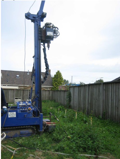
Figuur 8. Geoprobe waarmee directe injecties zijn uitgevoerd
