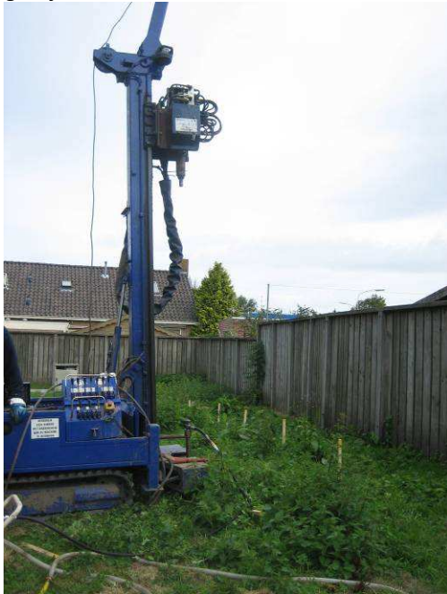
Figuur 8. Geoprobe waarmee directe injecties zijn uitgevoerd
