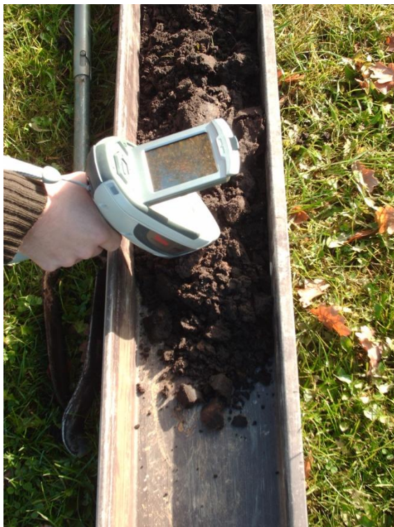
Foto 1: meten met de 'handheld' XRF
