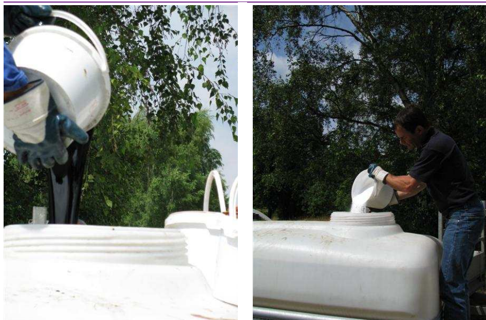
Figuur 6.2 Opmengen van het onttrokken grondwater met; links melasse en rechts \text{Na}_2\text{SO}_4
