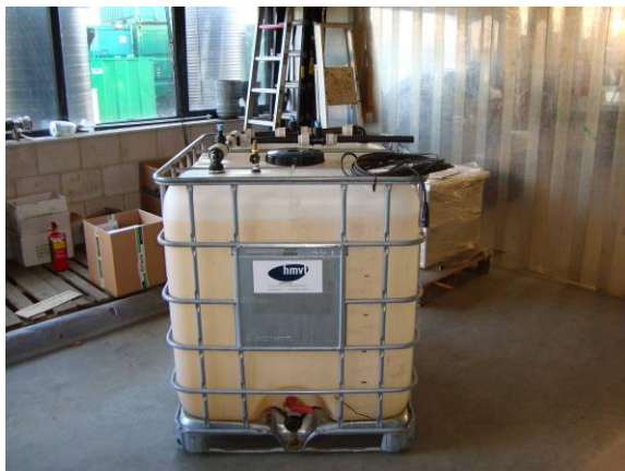
Figuur 9: multibox en koppeling met aansluiting op stikstofgas
