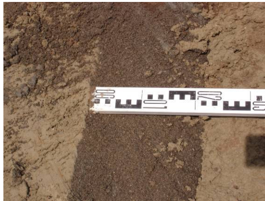
Figuur 4.8 Opmeten ijzerscherm
