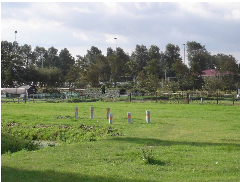
Figuur 5.2 Foto peilbuizen C1 t/m C6 ter plaatse van het ijzerscherm
