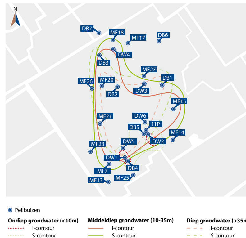
Figuur 11: VOCI-contouren grondwater Nieuw-Weerdinge
