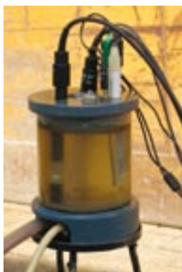
Figuur 14: Anaërobe bemonstering en on-line metingen ten behoeve van redoxmeting.
