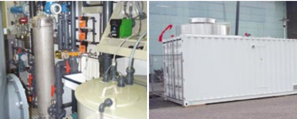
Figuur 12: Dosering- en pompsysteem voor de recirculatie van hulpstoffen en bacteriën (TCE-concept).
