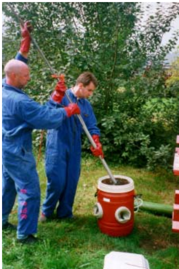
Foto 2. De zuigerboor wordt geleegd in het anaërobe monsternamevat.
