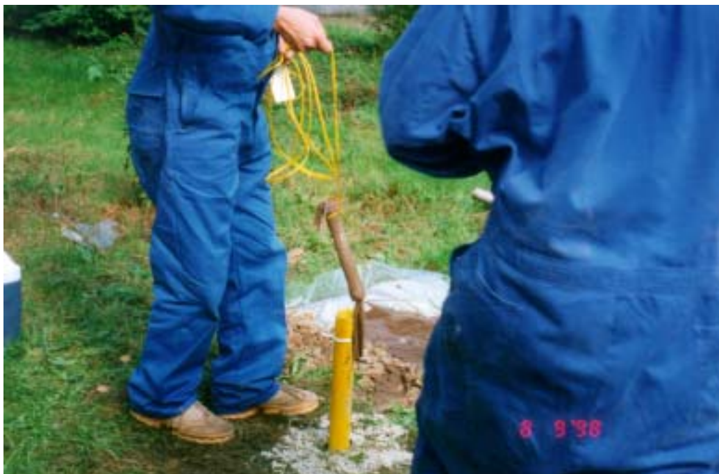
Foto 4. Het plaatsen van een mesocosm in de filterbuis.
