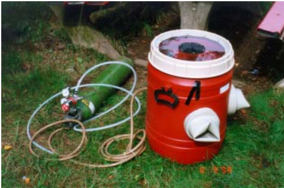
Foto 1. Het anaërobe monsternamevat, met de cylinder stikstofgas.
