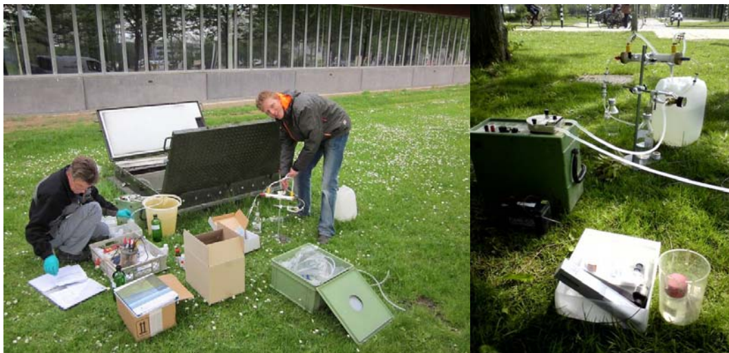
figuur 2.1 Peilbuis in WKO put op de Uithof wordt bemonsterd (links), opstelling van de kunstnier met een slangenpomp, kunstnier, afvalvat en monsterpotje (rechts)
