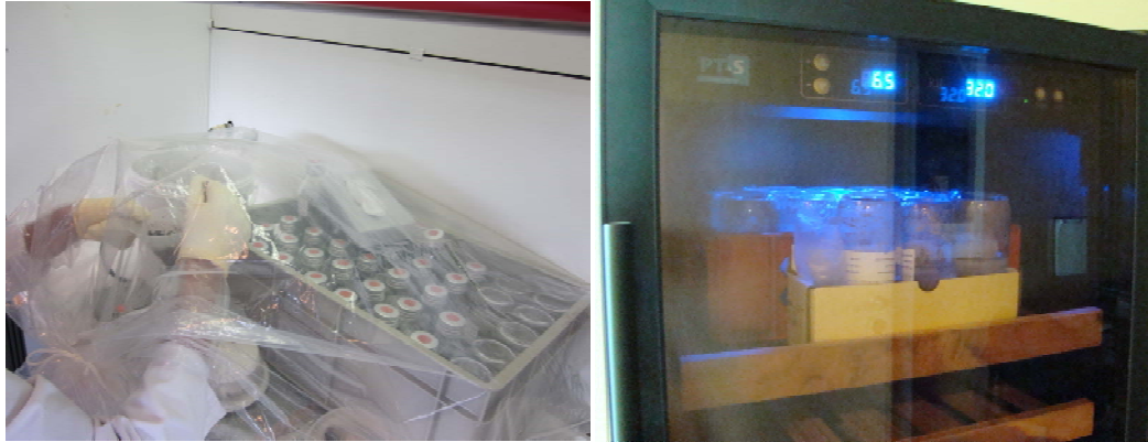
figuur 2.3 Inzetten afbraaktesten (rechts: anaeroob inzetten; links: klimaatkast)
