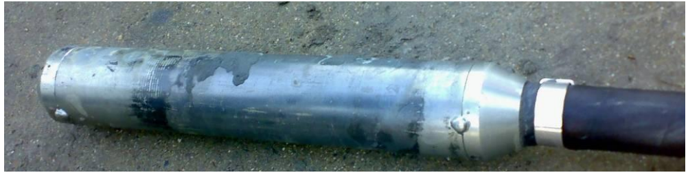
Figuur 2: Gebruikte trilnaald voor de Botlek en Doetinchem locaties.
