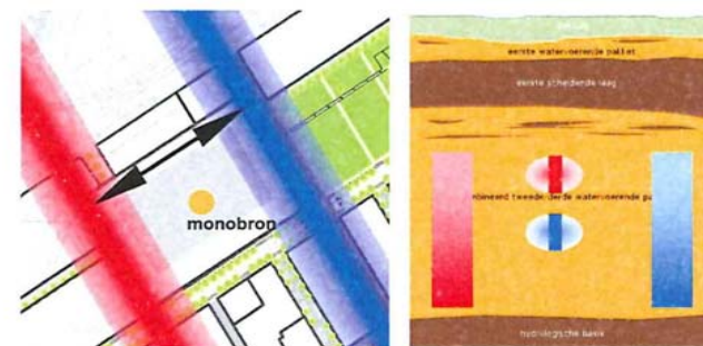
Figuur 5.1 variant 1: monobronstelsel tussen warme en koude strook in
