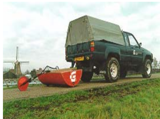
Uitvoering van metingen met grondradar
