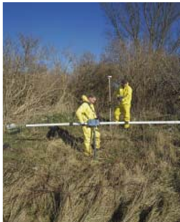
Uitvoering van EM-31 onderzoek op de Volgermeerpolder
