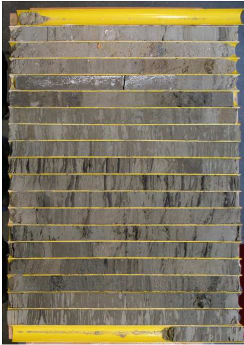
Figuur15: Begemanboring (de segmenten zijn 1m lang)
