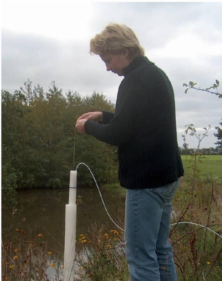
Foto 4. Plaatsen van de SorbiCell gemonteerd op het GWS40-systeem
