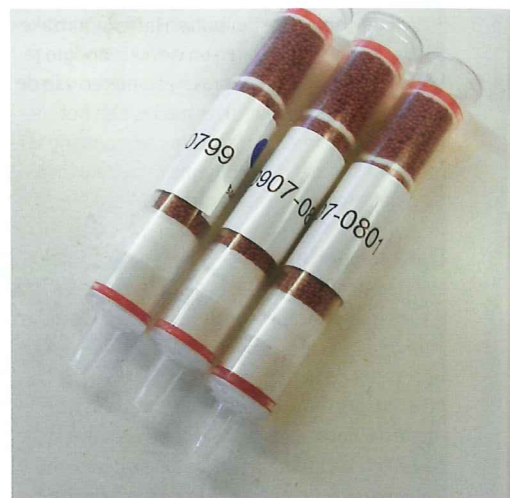
SorbiCells met de polymeerkorrels in twee compartimenten, spoorzout, filter en klemring. Het water stroomt via de polymeerkorrels door het tweede compartiment en het spoorzout.
