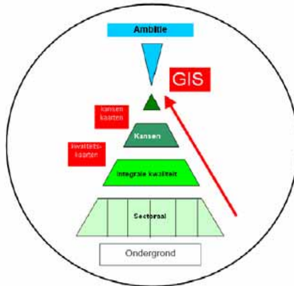
Figuur 1.5: Toegepaste methodiek: ondergrondinformatie vanuit de verschillende ondergronddisciplines (sectoren) gecombineerd gepresenteerd op kwaliteitskaarten en kansenskaarten; ambities van de gebiedsontwikkelaars gepresenteerd op ambitiekaarten. Mogelijkheden en ambities kunnen zo met elkaar worden geconfronteerd.
